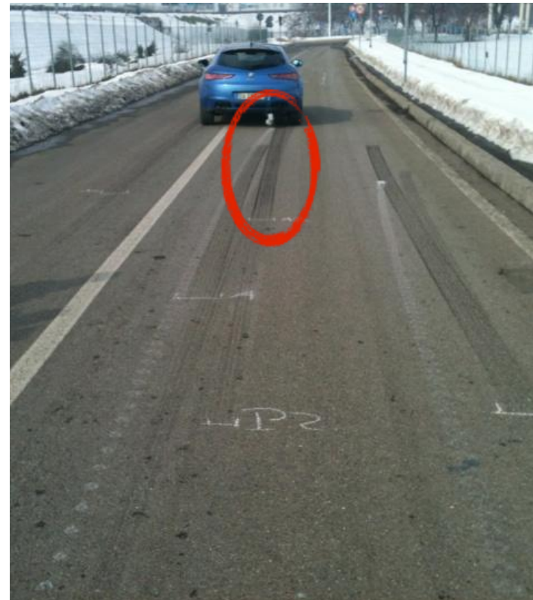
ABS disinserito: Tracce gommose continue
